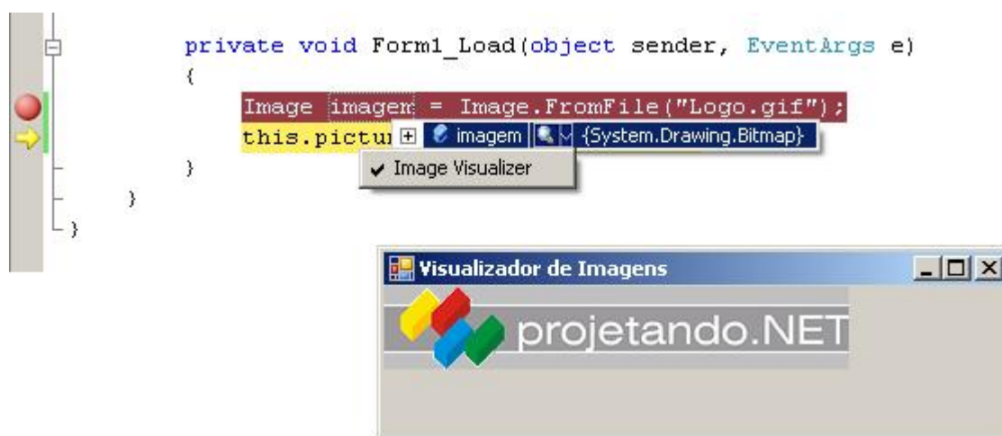
Imagem 4.6 – Utilizando Debug Visualizer customizado
